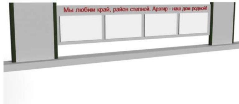
Конструкция изготовлена из черного листового металла 1,5-2,0 мм.
